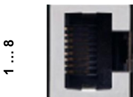
Abbildung 6: RS-232 / RS-485 Schnittstelle X17
