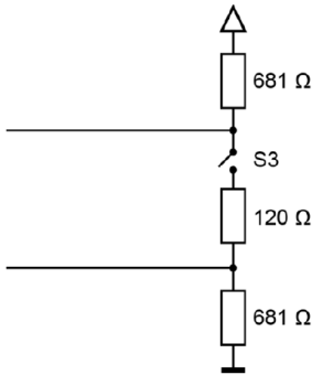
Abbildung 7: RS-485 zuschaltbarer Abschlusswiderstand
