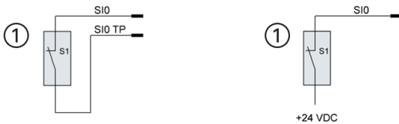
Abb. 20: Anschlussbeispiel einkanaliger Sensor
