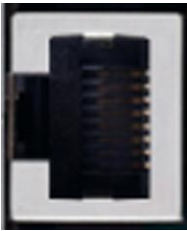
Fig. 16: RS-232/RS-485 interface X6
