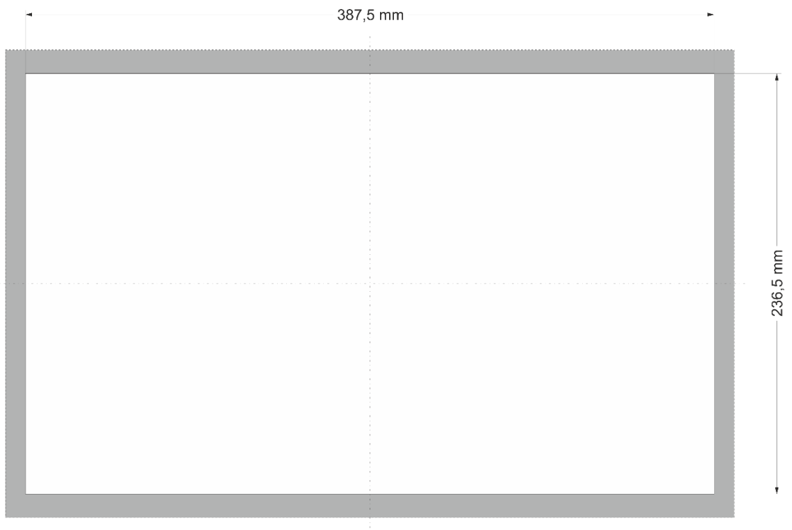
Abb. 8: Montageausschnitt DC-Pi Prime 15
