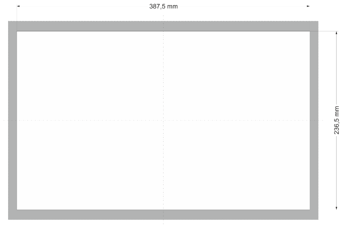
Abb. 8: Montageausschnitt DC-Pi Prime 15
